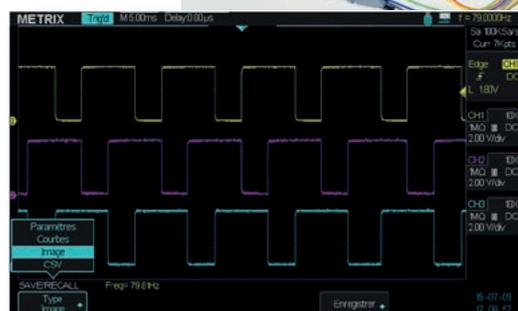
Gli oscilloscopi **DOX3000** oltre a offrire la funzione di decodifica, consentono la visualizzazione della trama analogica del segnale
