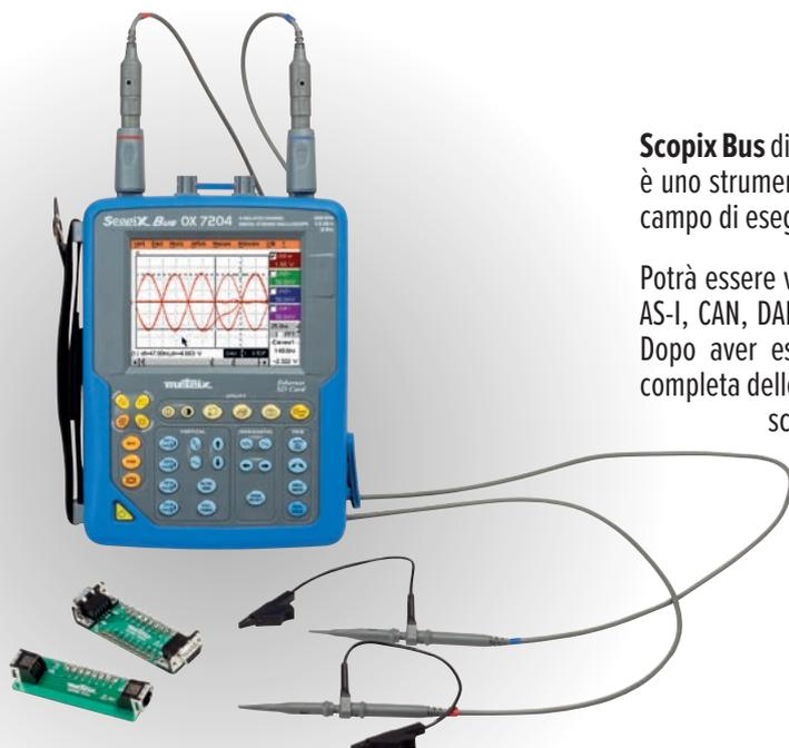
**Scopix Bus di Metrix®**, dalla costruzione robusta e dal semplice utilizzo, è uno strumento di misura che consente al tecnico che installa il bus di campo di eseguire questo tipo di analisi.
