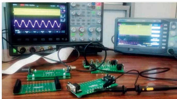
Gli strumenti LX1600-PC o DOX3000 sono in grado di decodificare i principali bus di campo.
