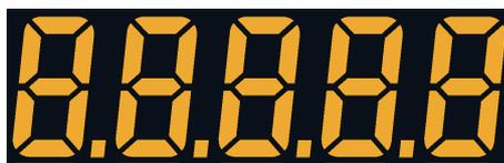
Visualización de la frecuencia (altura dígito 20 mm)
