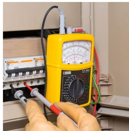
▲ **La linguetta articolata assicura la tenuta del C.A. 5003 in posizione verticale per un lettura ravvicinata al punto di controllo.**
