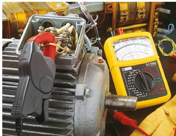
▲ **Letture diretta della corrente di un motore con il C.A. 5005 e la sua minipinza MN 89, fornita di serie.**
