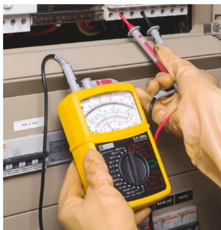
**Test di continuità di un fusibile con il C.A. 5001.** La linguetta articolata è in posizione di sostegno, per uso su tavolo. ▶
