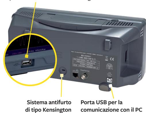
Dal pannello posteriore, le porte USB e RJ45 (Ethernet) abilitano la comunicazione con il PC tramite il software associato per il controllo, le verifiche e il recupero dei file contenenti le tracce e degli screenshot. La memoria interna degli oscilloscopi comprende 20 configurazioni e 10 forme d'onda. Per aumentare il livello di sicurezza, è presente un sistema antifurto di tipo Kensington, che permette di assicurare il dispositivo inserendo un lucchetto nell'apposito security slot.
