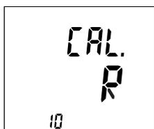
Per entrare nella procedura di taratura della misura d'impedenza, premete il tasto ► per più di 3 secondi.
