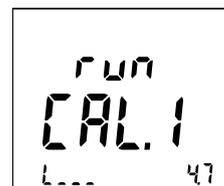
**Tappa 4/7.** Lo strumento procede alla seconda parte della taratura della misura di corrente.
