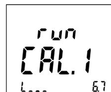
**Tappa 6/7.** Lo strumento procede alla terza parte della taratura della misura di corrente.
