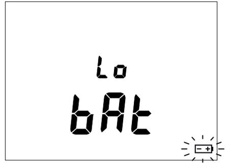
Es imprescindible entonces cambiar las pilas (véase § 4.2), al ya no ser fiable la indicación de la autonomía.
