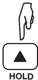
Pulsar la tecla **HOLD** congela la visualización de la medida. Esto se puede realizar con todas las funciones excepto en medida de tensión en la posición **MΩ**.
