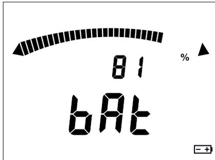
Si la tensión de las pilas es demasiado baja para garantizar un correcto funcionamiento del instrumento, lo indica.
