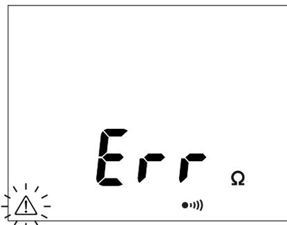
Durante la medida de continuidad o de resistencia, si el instrumento detecta una tensión externa superior a 15 V (alterna o continua), interrumpe la medida y muestra la siguiente pantalla.
