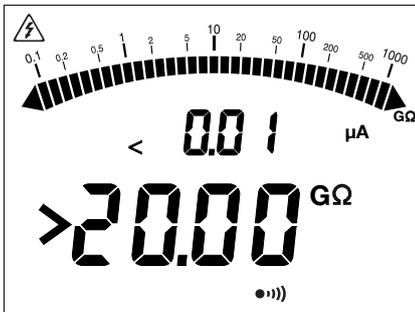
Durante la medida de aislamiento, si el valor a medir supera el rango de medida (el cual depende de la tensión de prueba), el instrumento lo indica.
