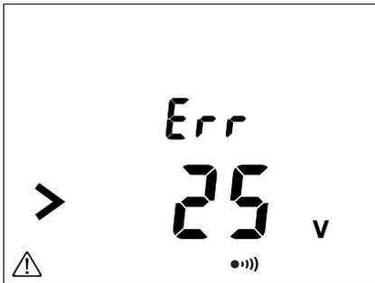
Antes de medir el aislamiento, el instrumento está en medida de tensión. Si una tensión superior a 25 V está presente en los bornes y usted intenta igualmente realizar una medida, el instrumento lo indica.
