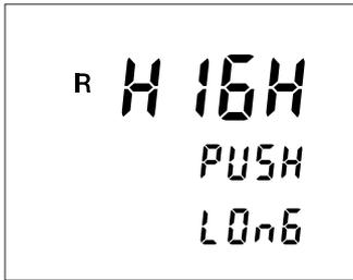
Ce message s'affiche lorsque la mesure a été déclenchée par un appui court sur le bouton START/STOP et que les résistances des piquets sont trop élevées.
