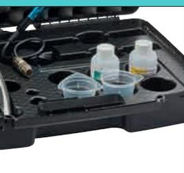
Calibración in situ facilitada gracias a un maletín de transporte relleno, con espacios para vasos de precipitado.
