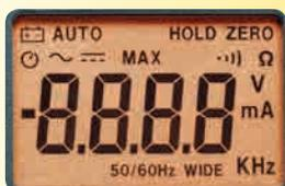
Pantalla LCD de 10.000 puntos con retroiluminación.
