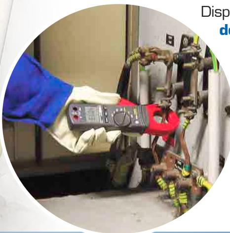
Disponen de una **pantalla de 10.000 puntos con retroiluminación**, función HOLD, funciones de **medida del valor máximo** y **medida diferencial** (Delta). A fin de garantizar una gran autonomía, ambas disponen de **apagado automático**, en caso de uso durante un tiempo prolongado.
