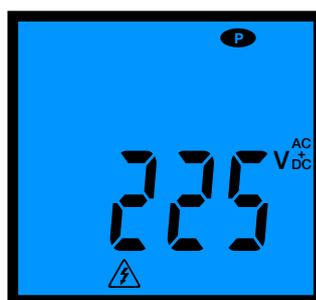
Misurazione della tensione e verifica del livello di carica di una batteria in posizione tensione
