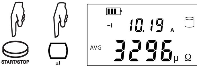
Invertire il senso della corrente premendo il tasto ±I, e l'apparecchio visualizza la media:
