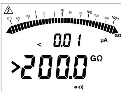
Durante la misura d'isolamento, se il valore da misurare supera la gamma di misura (che dipende dallo strumento e dalla tensione di prova), lo strumento lo segnala.
