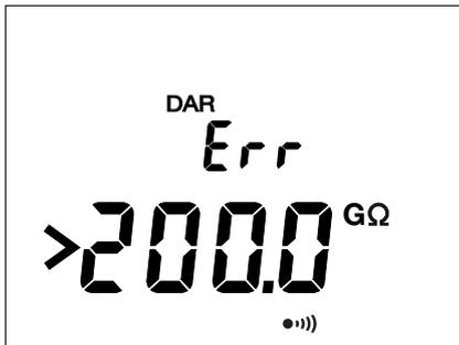
Per il C.A 6524 o il C.A 6526, se ciò si produce durante una misura di DAR o di PI, lo strumento interrompe la misura e visualizza il presente schermo.
