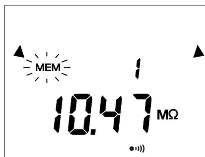
Essa viene registrata con tutte le informazioni correlate e che non sono necessariamente visualizzate al momento della memorizzazione: tensione, corrente, durata del test T1 e T2 nel caso di PI e DAR, ecc.
