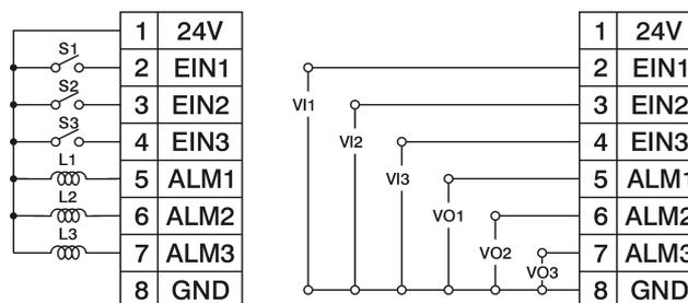
Fig: Wiring details
